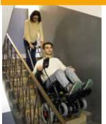
Система датчиков угла наклона обеспечивает безопасность и контроль управления.
